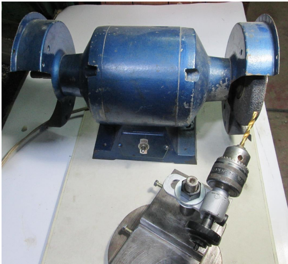
Figura 4-5: Afiladora de brocas acoplable a un esmeril de banco
